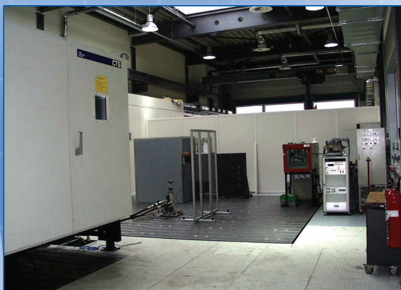
Motorenprüfungen können auch Klimatests beinhalten. Die Klimaprüfstände (-40°C bis +50°C) im Daimler Chrysler Test- und Entwicklungszentrum in Stuttgart werden mit Spezial-Luftfedern schwingungs isoliert. Diese Luftfedern bestehen aus Silikon, um den Temperaturschwankungen zu widerstehen. Die Oberfläche der Graugußspannplatten wurde zum Korrosionsschutz chemisch vernickelt.
