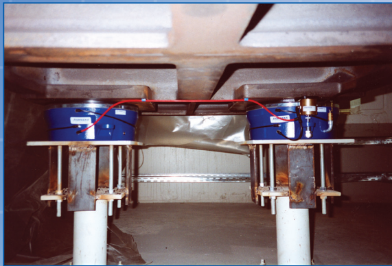
Unter jeder Prüfstandsplatte befinden sich acht Luftfederelemente mit einer Eigenfrequenz von 2,5 Hz. Insgesamt 22 Prüfstände wurden bei KST installiert.
