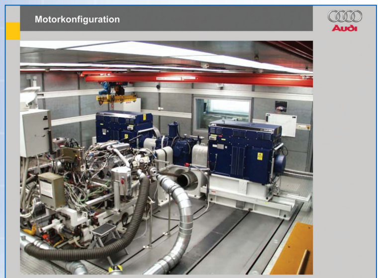
Der Prüfaufbau besteht aus 2 Belastungsmaschinen, dem Fahrzeuggetriebe und dem Antriebsmotor, montiert auf einer gemeinsamen Prüfstands-Fundamentplatte. Der gesamte Prüfstand mit Spannplatte ist auf Luftfedern gelagert (Eigenfrequenz 2,5 Hz).
